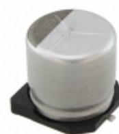
HHXB630ARA560MJA0G United Chemi-Con CAP ALUM POLY HYB 56UF 63V SMD
