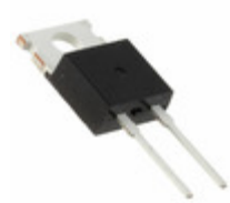
DGS10-030A IXYS DIODE SCHOTTKY 300V 11A TO220AC
