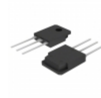
DSSK80-003B IXYS DIODE ARRAY SCHOTTKY 30V TO247AD
