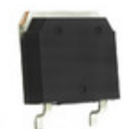
IXFT80N20Q IXYS MOSFET N-CH 200V 80A TO-268
