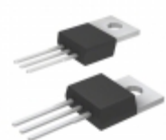
IXFP8N85X IXYS MOSFET N-CH 850V 8A TO220AB
