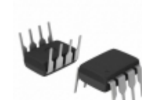
AQW214E Panasonic RELAY OPTO DPST-NO 100MA 400V
