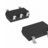
RT9013-26GB Richtek USA Inc. IC REG LDO 2.6V 0.5A SOT23-5
