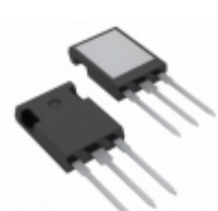
IXFR90N30 IXYS MOSFET N-CH 300V 75A ISOPLUS247
