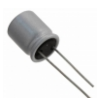
RR70G122MDN1PH Nichicon CAP ALUM POLY 1200UF 20% 4V T/H
