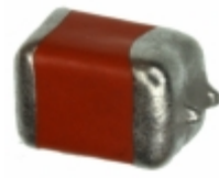
13008-071KESZ Vishay Sprague CAP TANT 15UF 50V 10% 2917
