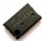
SG-8002JF 100.0000M-PCMR0 ROHS Epson OSC XO 100MHZ CMOS SMD
