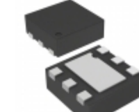
RT9030-18GQW Richtek USA Inc. IC REG LDO 1.8V 0.15A 6WDFN
