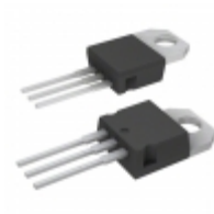
TIP36-S Bourns Inc. TRANS PNP 40V 25A
