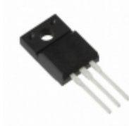
IRFIBC40GLC Vishay Siliconix MOSFET N-CH 600V 3.5A TO220FP
