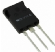
IXKR40N60C IXYS MOSFET N-CH 600V 38A ISOPLUS247
