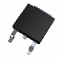
AUIRGR4045DTRL Infineon Technologies IGBT 600V 12A 77W DPAK
