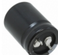
LGU1E682MELZ Nichicon CAP ALUM 6800UF 20% 25V SNAP
