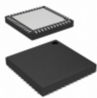
CY8C20646AS-24LQXI Cypress Semiconductor IC PSoC 16KB FLASH 48QFN
