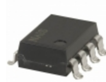
AQH1213AX Panasonic SSR AC MOD 0.6A ZERO 600V SMD
