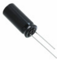
EEU-FS0J682L Panasonic CAP ALUM 6800UF 20% 6.3V T/H
